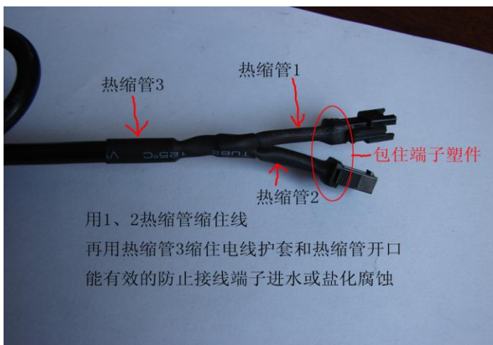
(引线端子处防盐化与腐蚀处理图)
